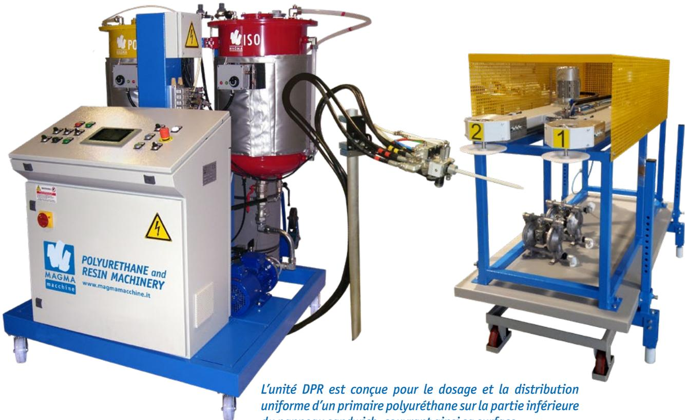
*L'unité DPR est conçue pour le dosage et la distribution uniforme d'un primaire polyuréthane sur la partie inférieure du panneau sandwich, couvrant ainsi sa surface.*
