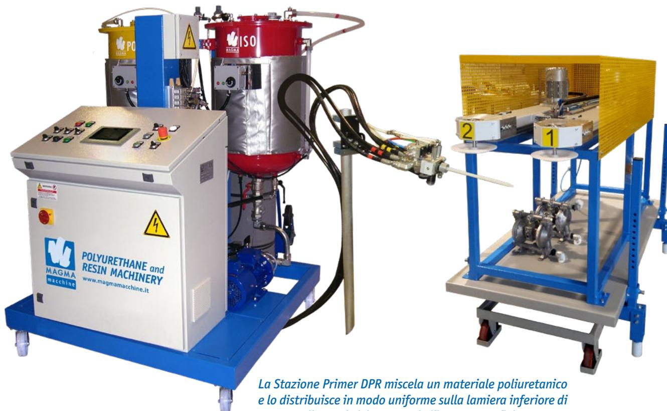
*La Stazione Primer DPR miscela un materiale poliuretano e lo distribuisce in modo uniforme sulla lamiera inferiore di un pannello sandwich, coprendo l'intera superficie.*
